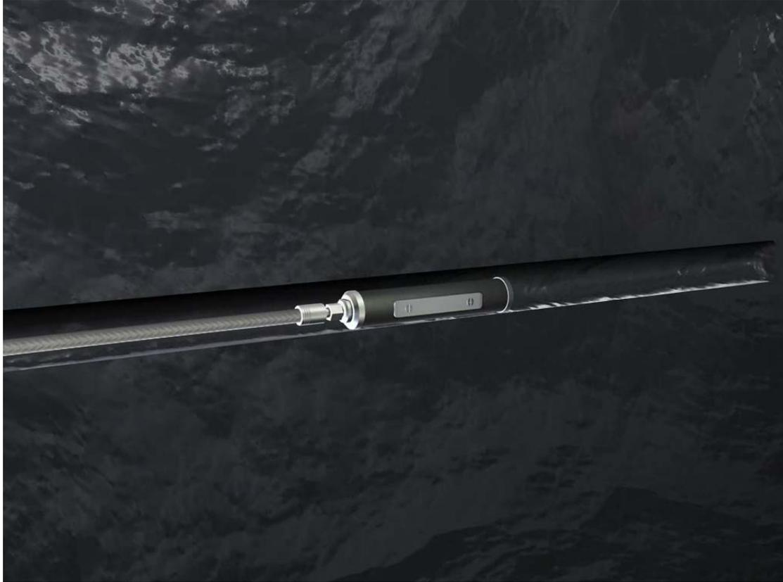
检波器互为垂直的双分量水平检波器，直径为 55mm。检波器插入煤层中的孔洞后，用气筒给检波器气囊充气使其膨胀，以便检波器紧紧的贴在巷道壁上。在移出检波器时，只需轻轻按下阀门便可释放橡胶囊内部气体。重 3.3Kg。
