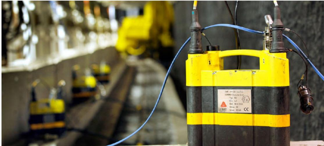
地下煤矿采掘生产是在地下岩矿层中进行的，对于煤矿巷道掌子面前方可能造成安全事故的不良地质体，如陷落柱、采空区、富水带等急需远距离探查技术。煤矿地质灾害如煤矿突水、透水事故、瓦斯爆炸等成为煤矿安全生产主要威胁，严重危害着煤矿的安全生产。针对这一现状，我公司独家从德国引进目前国际先进的井下地质勘测仪器：煤矿地质灾害勘测仪，并且研制开发了与其相关的软件系统：TST 煤矿灾害超前预报系统。该预报系统为本安型防爆设计，可用于探测煤矿断层、破碎带、岩溶陷落柱、采空区等地质对象，预报瓦斯与地下水突出部位。预报方位为巷道前方、巷道侧向、巷道间；预报距离为 100-200 米。通过该系统的超前预报，增强了煤矿开采的计划性和对事故隐患的预见性，保证煤矿的安全生产，降低煤矿事故率。
