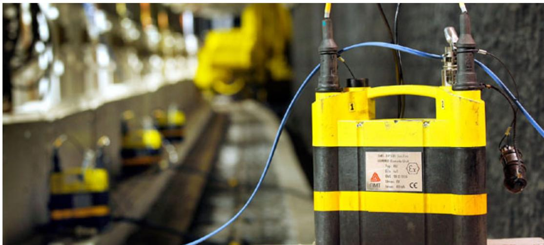
外壳为导电塑料材质，具极高防爆功能，有 2 个状态指示灯 LED 指示采集站工作状态，重
